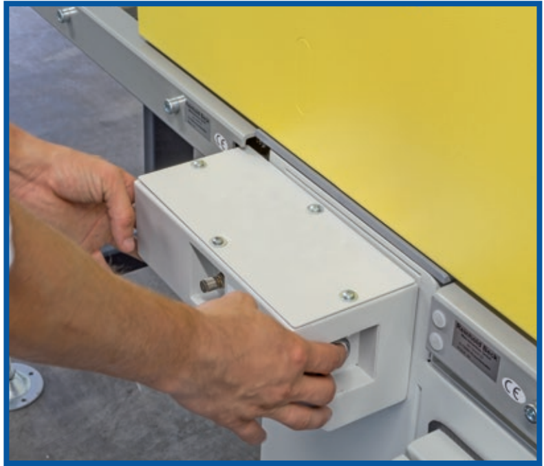
Éléments de commande „Commande de sécurité bimanuelle” Double sécurité – commande bimanuelle pour déplacement de la lame de scie. Réglage de l’avance de la lame de scie par vis.
